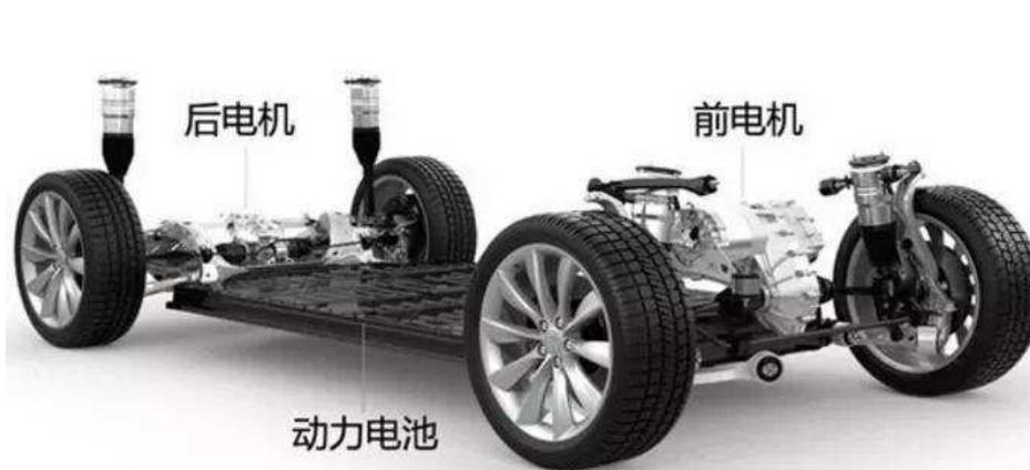
单电机驱动总成需用轴承 12 套，双电机驱动总成需用轴承 20 套。
