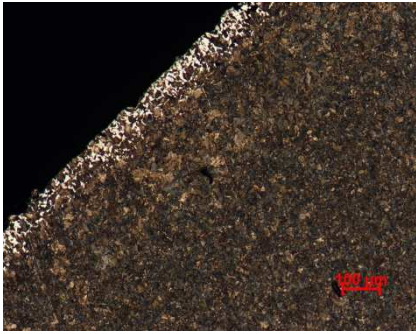
图 3 高速锻件表面脱贫碳层
