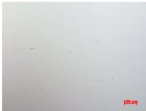
图 5 试验钢中的夹杂物
